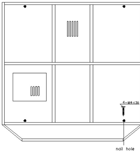
Montieren Sie die Staubschutzhaube auf dem Dach
