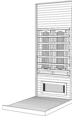
(2) Setzen Sie die Rückwand an die Bodenplatte.
