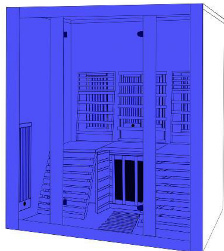
(13) Einbau der Frontplatte in die linke und rechte Platte mit voreingestellten Außenschnallen
