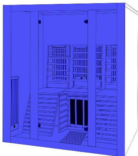
(13) Инсталирайте предния панел към левия панел и десния панел с предварително зададени външни катарамы
