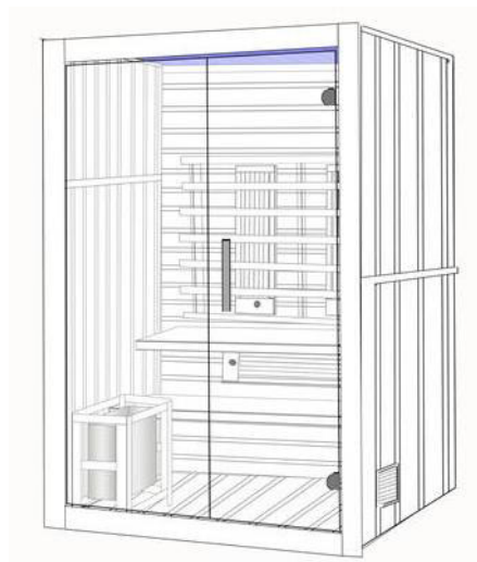
(10) Namontujte kryt protiprachové stříšky na instalované boční panely
